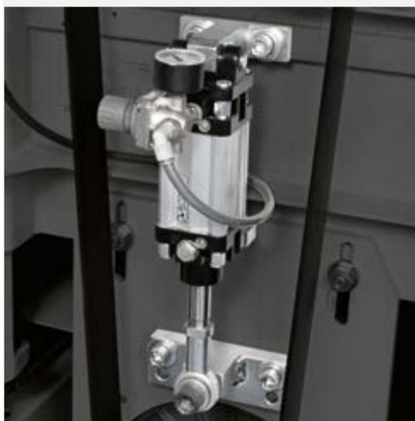
Группа вала имеет систему автоматического натяжения ленты, что позволяет постоянно поддерживать корректное натяжение и обеспечивает максимальную эффективность передачи мощности двигателя. Это устройство особенно важно при операциях калибрования вследствие передачи всей мощности на обработку
