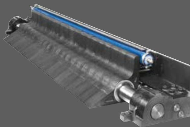
Система **фронтального доступа к строгальному валу** делает более удобными операции по **очистке и техническому обслуживанию**.
