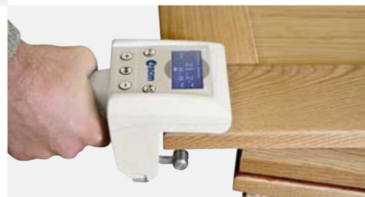
Электронный беспроводной измеритель позволяет позиционировать рабочие группы станка по толщине, измеренной данным устройством. Обмен данными со станком производится без лишних проводов, а также дает возможность производить дистанционный вызов нужной программы обработки.
