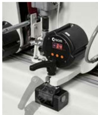
Система быстрой фиксации рабочих групп на станине и цифровое отображение рабочей координаты делают операции по замене абразивной ленты и настройке станка чрезвычайно быстрыми и точными.
