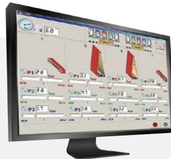
Система "PWM" полностью контролируется электронным управлением "MAESTRO PRO-SAND". Благодаря современному интерфейсу оператора, специально разработанного компанией SCM, имеется возможность отображать и настраивать все параметры срабатывания устройства и сохранять их в виде отдельных программ.
