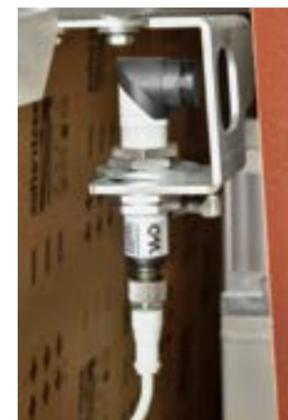
Система центрирования абразивной ленты управляется фотоэлементом с отражением от объекта, очень точным и надёжным, обеспечивающим корректное позиционирование
