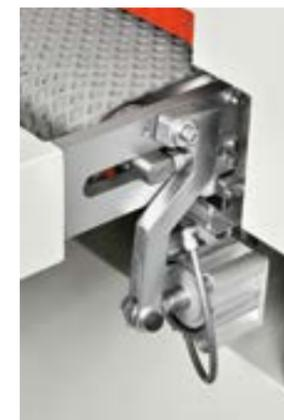
Устройство автоматической центрирования ленточного транспортёра: электропневматическая система постоянно поддерживает ленточный транспортёр в нужном положении без какого-либо вмешательства со стороны оператора.
