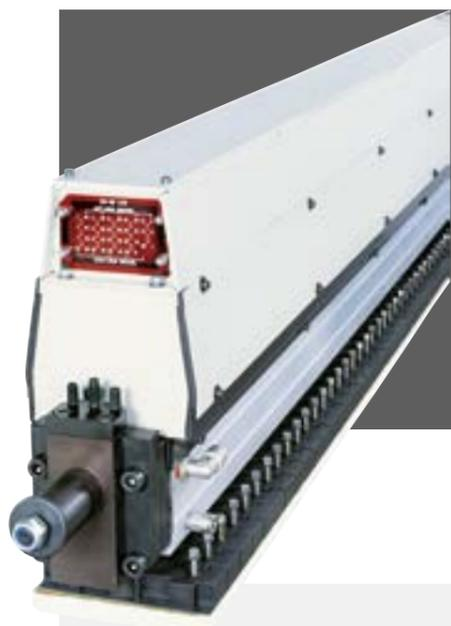
Секционный утюжок "EPICS" состоит из специальной монолитной поперечины, внутри которой размещены пневмоцилиндры для активации отдельных сегментов. Благодаря большому шагу поршней и двухходовой системе (регулируемое прямое и обратное пневматическое нажатие) утюжок "EPICS" обеспечивает **максимальную чувствительность и точность при любом типе обработки.**
