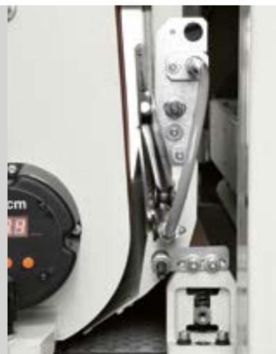
Автоматическое устройство позиционирования рабочего стола определяет толщину детали и позволяет производить точную обработку без риска совершить ошибку со стороны оператора.
